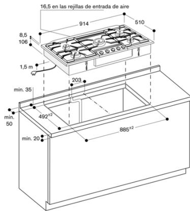
Distancia mínima entre el hueco del aparato y la pared lateral: 300 mm.
