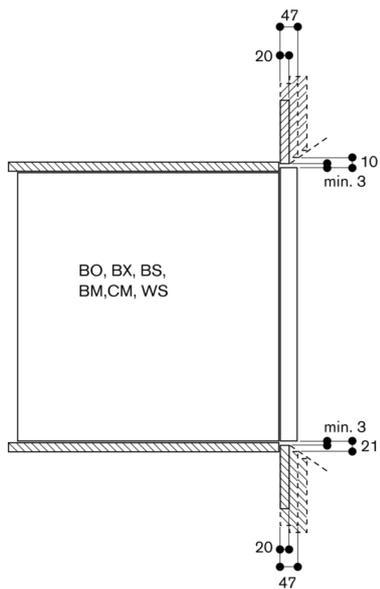
Section de l'entrée d'air au niveau des bords de la porte
