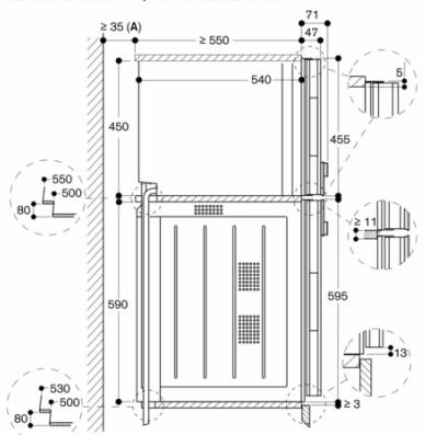
A : uniquement requis lorsque les tuyaux d'eau du BS ne peuvent pas être amenés dans les évidements en coin des appareils.
