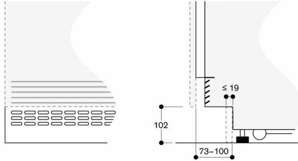
Selon la hauteur d'installation standard, la hauteur de la plinthe est de 102 mm
