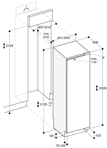
Les dimensions maximales de la façade de la porte comprennent un entrebaillement de 3 mm.
