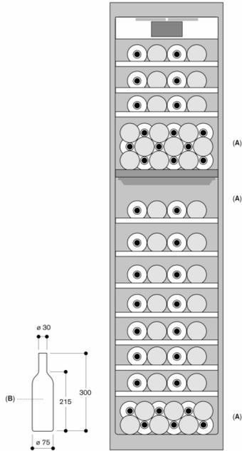
A: Zone adaptée au stockage de bouteilles magnum dans une configuration de plateau standard
