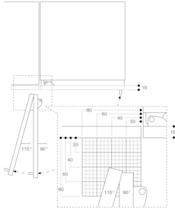
La course de la charnière et les distances en résultant par rapport au meuble avoisinant et aux poignées du meuble sont indiquées sur le schéma en fonction de l'épaisseur de la partie frontale. Sur ce schéma, l'épaisseur de la partie frontale utilisée est de 19 mm.
