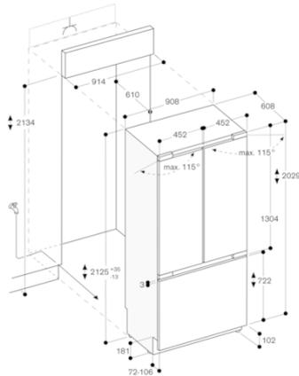
Les dimensions maximales du panneau d'habillage sont prévues pour une fente de 3 mm.
