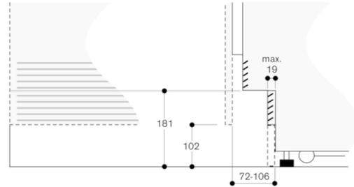
Par rapport à la hauteur standard de l'appareil, la hauteur de la plinthe est de 102 mm. Epaisseur maximale de la plinthe 19 mm.
