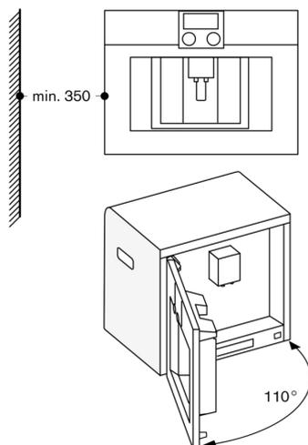
Dans le cas de l'utilisation de la contrainte articulée à 92° (Pièce de rechange N° 00636455), l'espace minimal avec la paroi est de seulement 100 mm.
