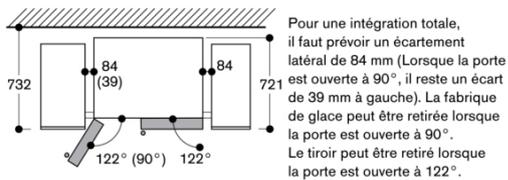
Pour une intégration totale, il faut prévoir un écartement latéral de 84 mm (Lorsque la porte est ouverte à 90°, il reste un écart de 39 mm à gauche). La fabrique de glace peut être retirée lorsque la porte est ouverte à 90°. Le tiroir peut être retiré lorsque la porte est ouverte à 122°.
