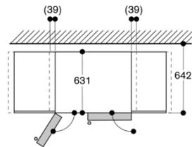
La porte s'ouvre uniquement à 100° si le boîtier de l'appareil est intégré aux unités de meubles adjacentes. Pour une ouverture de porte à 122°, une distance de 39 mm est requise.
