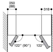
Pour l'installation à côté d'un mur latéral, il faut prévoir un écart de 250 mm à gauche et de 318 mm à droite afin que la fabrique de glace et les tiroirs puissent être retirés. Lorsque la porte est ouverte à 90°, il reste un écart de 88 mm à gauche. Les tiroirs ne peuvent alors pas être retirés.
