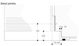
En se référant à la hauteur standard de l'appareil, la hauteur de la plinthe s'élève à 102 mm. L'épaisseur maximale de la plinthe est de 19 mm.
