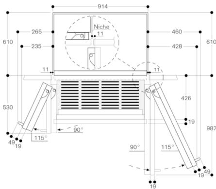
Le schéma suppose une épaisseur de partie frontale de 19 mm
