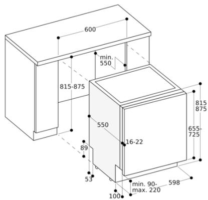
Dimensions de raccordement pour un lave-vaisselle de 60 cm de large
