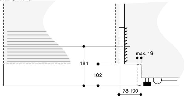
En se référant à la hauteur standard de l'appareil, la hauteur de la plinthe s'élève à 102 mm. L'épaisseur maximale de la plinthe est de 19 mm.
