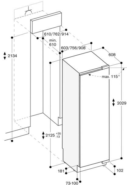
Les dimensions maximales de la façade de la porte comprennent un entrebaillement de 3 mm.
