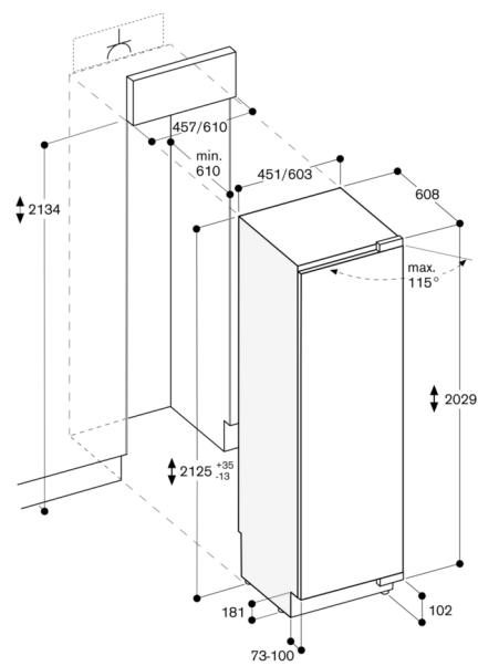
Les dimensions maximales de la façade de la porte comprennent un entrebâillement de 3 mm.
