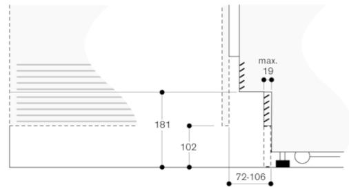
Par rapport à la hauteur standard de l'appareil, la hauteur de la plinthe est de 102 mm. Epaisseur maximale de la plinthe 19 mm.
