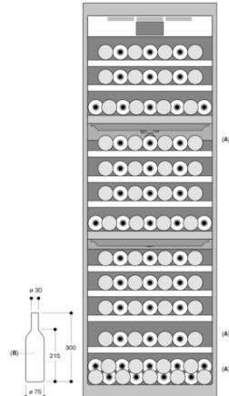
A: Zone adaptée au stockage de bouteilles magnum dans une configuration de 12 bouteilles. B: Niveau standard
