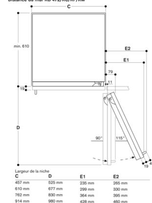
Le schéma prend en compte une épaisseur de la façade du meuble de 19 mm ainsi qu'une hauteur de poignée du meuble Gaggenau de 49 mm.
