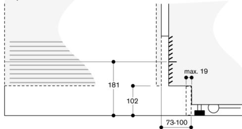
En se référant à la hauteur standard de l'appareil, la hauteur de la plinthe s'élève à 102 mm. L'épaisseur maximale de la plinthe est de 19 mm.
