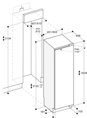
Les dimensions maximales de la façade de la porte comprennent un entrebâillement de 3 mm.
