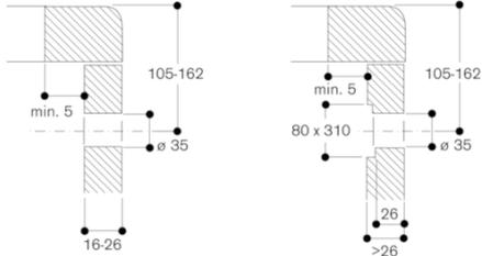
Installation du bouton de commande, encastrement affleurant
