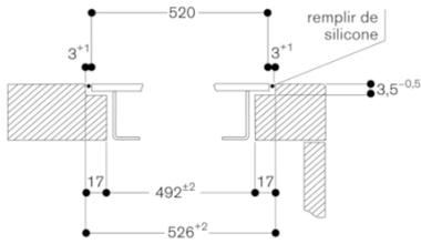
En cas d'installation avec couvercle ou joint de recouvrement, tenir compte de la découpe profonde et de la largeur de rainure à l'avant et à l'arrière.
