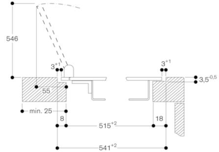
Installation du bouton de commande, montage sur le plan de travail
