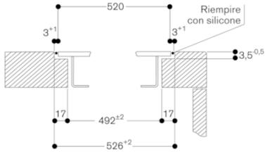
In caso di montaggio con coperchio apparecchio o listello di compensazione, prestare attenzione all'apertura più profonda e alla larghezza della scanalatura anteriore e posteriore.
