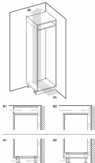
A: Ingresso aria  $\geq 200 \text{ cm}^2$ ; opzioni ventilazione A1 o A2
