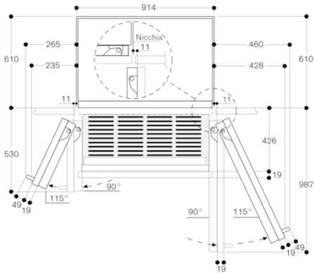
Il disegno si basa sullo spessore del frontale di 19 mm e l'altezza di una maniglia Gaggenau di 49 mm.
