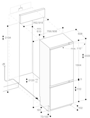
Le dimensioni massime del pannello porta sono progettate per una distanza di 3 mm.
