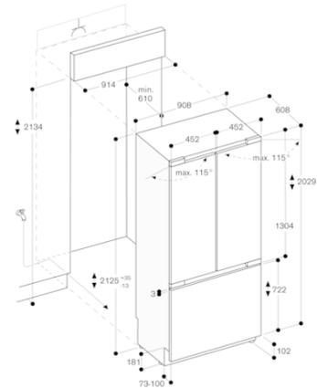
Le dimensioni massime del pannello porta sono progettate per una distanza di 3 mm.
