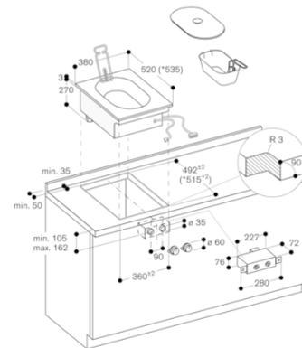
\* con coperchio apparecchio o listello di compensazione. Osservare le precauzioni di montaggio separate.
