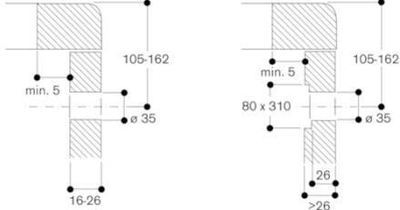
Montaggio manopola di comando, installazione a filo
