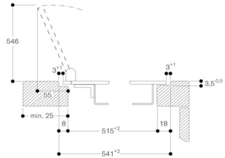
Montaggio manopola di comando, installazione in appoggio sopra il top
