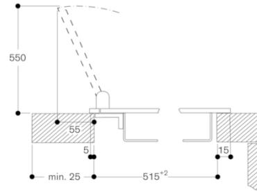
Montaggio con coperchio apparecchio / listello di compensazione, montaggio a filo
