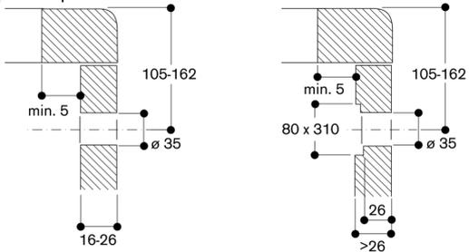
Montaggio manopola di comando, installazione a filo
