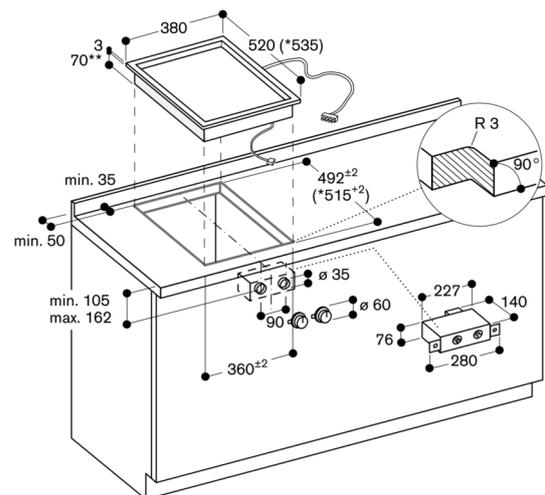
\* con coperchio apparecchio o listello di compensazione. Osservare le precauzioni di montaggio separate.
