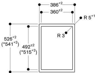
\* con coperchio apparecchio o listello di compensazione (Tenere presente la collocazione asimmetrica anteriore e posteriore, vedere le istruzioni separate "Montaggio con coperchio apparecchio/listello di compensazione").
