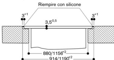
AL 400 foro d'incasso per installazione in appoggio sopra il top
