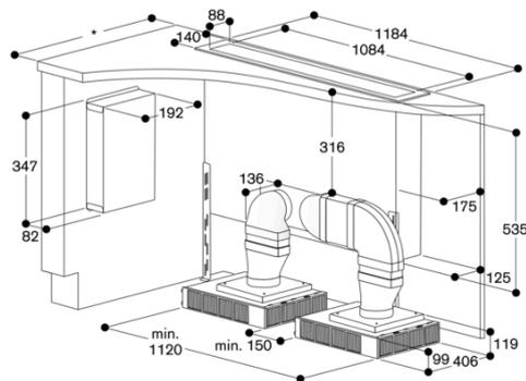
\* Tutti i piani cottura con profondità del foro d'incasso 492: min. 750
