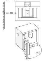
Utilizzando una limitazione della cerniera di  $92^{\circ}$  (cod. pezzo di ricambio 00636455), la distanza minima dalla parete è di soli 100 mm.
