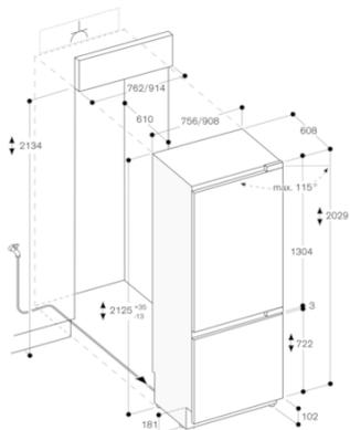
Le dimensioni massime del frontale dell'anta sono progettate per una luce di 3 mm.
