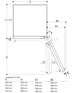
Il disegno si basa sullo spessore del frontale di 19 mm e l'altezza di una maniglia Gaggenau di 49 mm.
