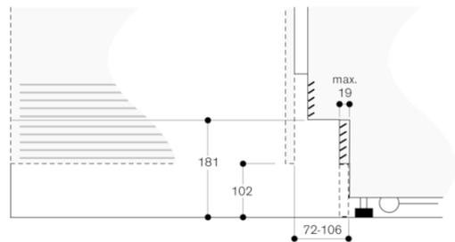
Riferita all'altezza standard dell'apparecchio, l'altezza dello zoccolo è di 102 mm. Spessore massimo dello zoccolo 19 mm.
