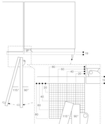
Il percorso della cerniera e le rispettive distanze dai mobili e dalle maniglie adiacenti possono essere dedotti dal disegno in base allo spessore del frontale. Nel disegno si prende in considerazione uno spessore del frontale di 19 mm.
