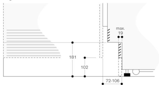
Riferita all'altezza standard dell'apparecchio, l'altezza dello zoccolo è di 102 mm. Spessore massimo dello zoccolo 19 mm.
