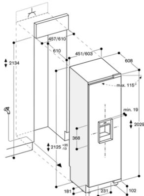
Le dimensioni massime del frontale dell'anta sono progettate per una luce di 3 mm.
