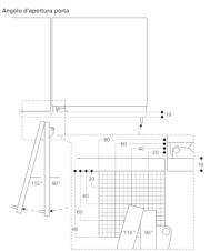
Il percorso della cerniera e le rispettive distanze dai mobili e dalle maniglic adiacenti possono essere dedotti dal disegno in base allo spessore del frontale. Nel disegno si prende in considerazione uno spessore del
