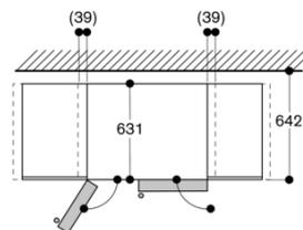
L'anta si apre solo di 100° se l'ingombro dell'apparecchio è integrato con le unità di mobili adiacenti. Per un'apertura dell'anta di 122° è necessaria una distanza di 39 mm.
