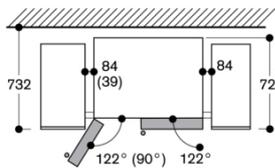
In caso di incasso completo lasciare da entrambi i lati una distanza di 84 mm (con apertura dell'anta di 90° a sinistra è ammessa una distanza di 39 mm). Con l'apertura dell'anta di 90° può essere estratto l'ice maker. La rimozione del cassetto è possibile con un'apertura dell'anta di 122°.
