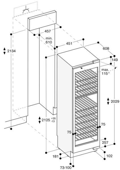
Le dimensioni massime del pannello porta sono progettate per una distanza di 3 mm.
