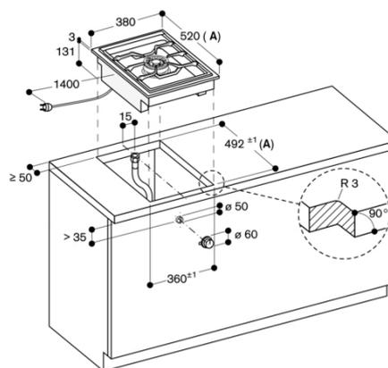
A: In caso di montaggio con coperchio apparecchio tenere presente il foro d'incasso più profondo (osservare le precauzioni di montaggio separate)
