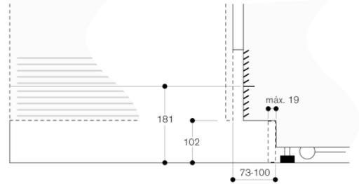
Relativamente à altura padrão do aparelho, a altura do rodapé é de 102 mm. Espessura máxima do rodapé 19 mm.
