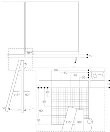
O espaço necessário para a dobradiça e as distâncias daí resultantes em relação ao móvel adjacente e as pegas dos móveis estão indicados no desenho, dependendo da espessura do painel frontal. No desenho é presumida uma espessura do painel frontal de 19 mm.
