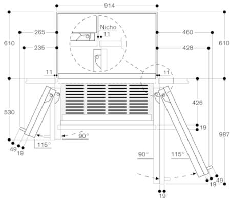
O desenho teve por base uma espessura do painel frontal de 19 mm e a altura de um puxador de móvel da Gaggenau de 49 mm.
