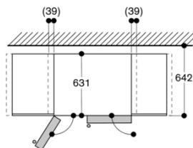
Quando a caixa do aparelho está integrada com módulos de mobiliário adjacentes, a porta abre-se apenas a 100°. Para uma abertura da porta de 122° é necessária uma distância de 39 mm.
