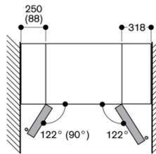
Em caso de integração junto a uma parede lateral, tem de ser prevista uma distância do lado esquerdo de 250 mm e do lado direito de 318 mm, para que seja possível retirar a máquina de fazer gelo e as gavetas.
