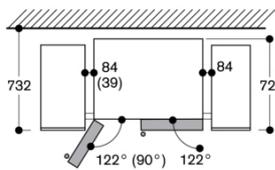
Em caso de integração total têm de ser previstas distâncias laterais de 84 mm (com abertura de porta de 90° é permitida uma distância do lado esquerdo de 39 mm). Com abertura de porta de 90°, a máquina de fazer gelo pode ser retirada. É possível retirar as gavetas com uma abertura de porta de 122°.
