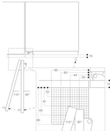
O espaço necessário para a dobradiça e as distâncias daí resultantes em relação ao móvel adjacente e às pegas dos móveis estão indicados no desenho, dependendo da espessura do painel frontal. No desenho é presumida uma espessura do painel frontal de 19 mm.
