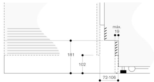
Com base na altura padrão do aparelho, a altura do rodapé é de 102 mm. A espessura máxima do rodapé é de 19 mm.
