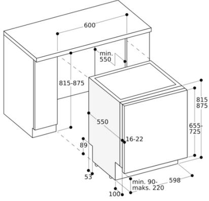
60 cm genişliğinde bulaşık makinesi için bağlantı ölçüleri
