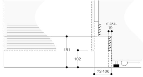
Cihazların standart yüksekliğine göre taban çitasının yüksekliği 102 mm'dir. Taban çitasının maksimum kalınlığı 19 mm'dir.
