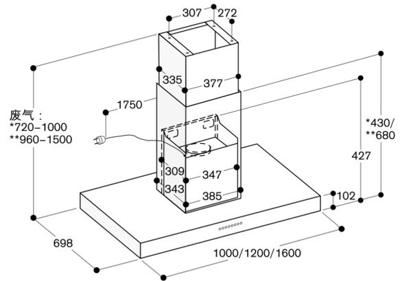
\* 带废气烟卤 AD 442 016 ，适用于 2.35 m 至 2.60 m 的天花板高度。
