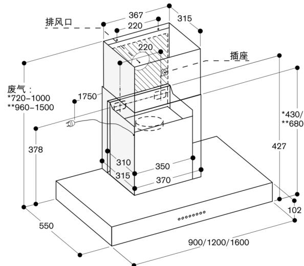
\* 带废气烟囱 AD 442 012 , 适用于 2.35 m 至 2.60 m 的天花板高度。
