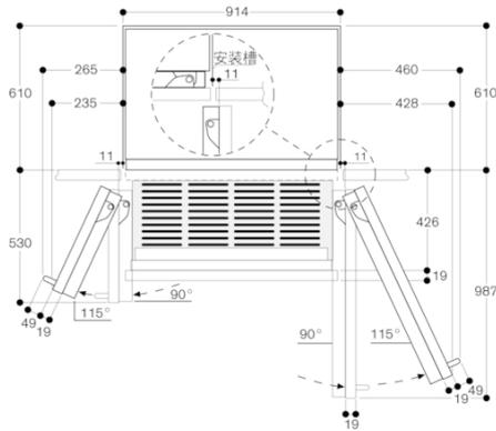
图纸中的尺寸基于 19 mm 的橱柜前面板厚度以及 49 mm 的 Gaggenau 橱柜把手高度。
