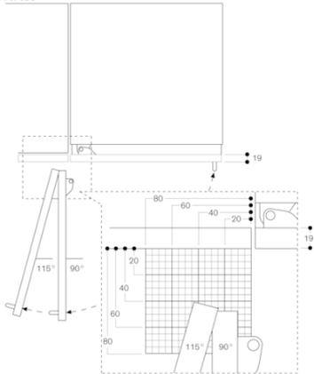
铰链通道和由此产生的与相邻家具和家具把手之间的距离可根据前端厚度从图纸中获知。图纸中的家具前端厚度为 19 mm。
