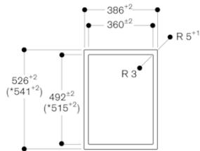
\* 带设备盖板或补偿板条 (注意前后接触面不对称 见单独的说明“带设备盖板/补偿板条的安装”)。
